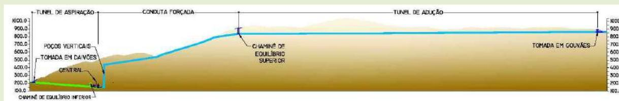
Figura 3: Circuito hidráulico de Gouvães
