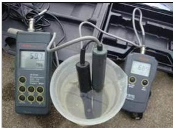
FIG II. 1 - Medição do pH, Temperatura e Condutividade com recurso a sondas portáteis
