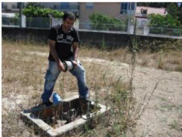
FIG. II. 2 - Medição da coluna seca com recurso a sonda portátil
