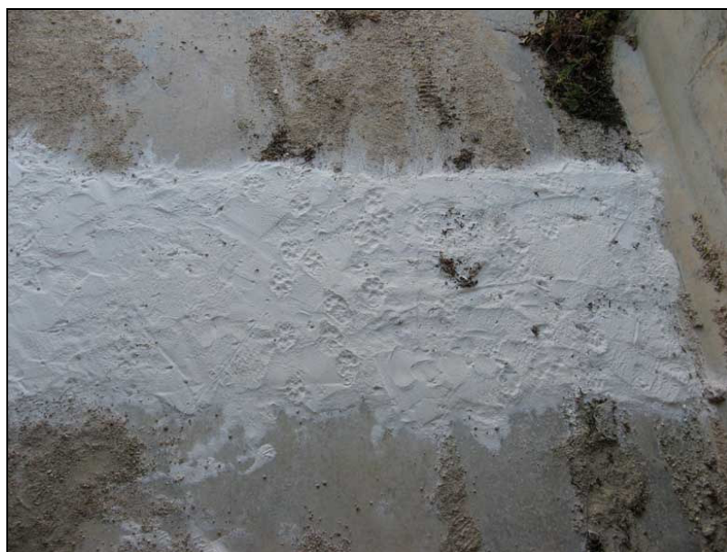
Figura 3.1 – Exemplo da utilização de pó de pedra para impressão de pegadas e rastros dos animais (passagem para a fauna no sublanço Guarda-Vilar Formoso).
