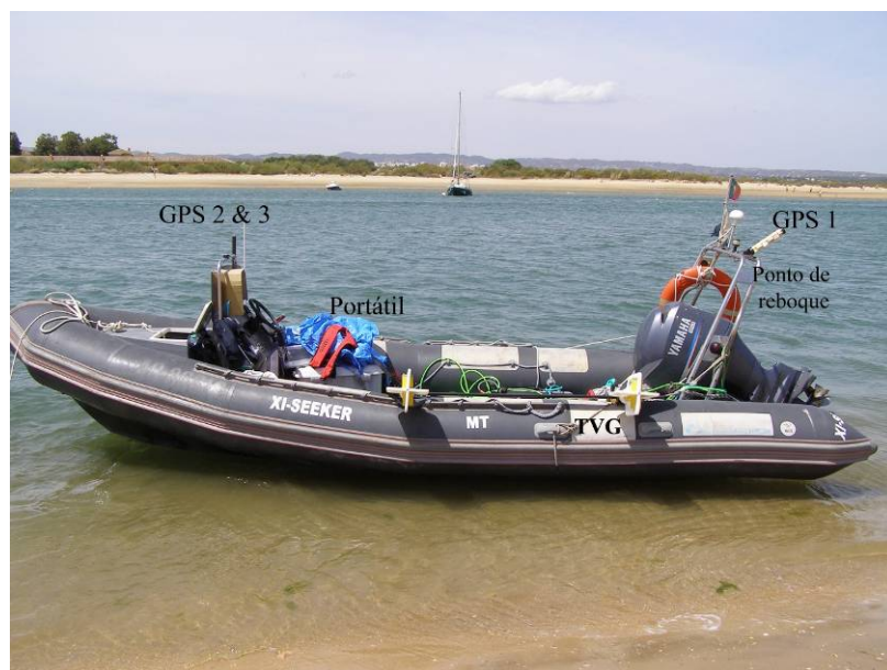
Figura 10 – Embarcação configurada para aquisição de dados por gradiometria. (Foto: Mikhail Tchernychev)
