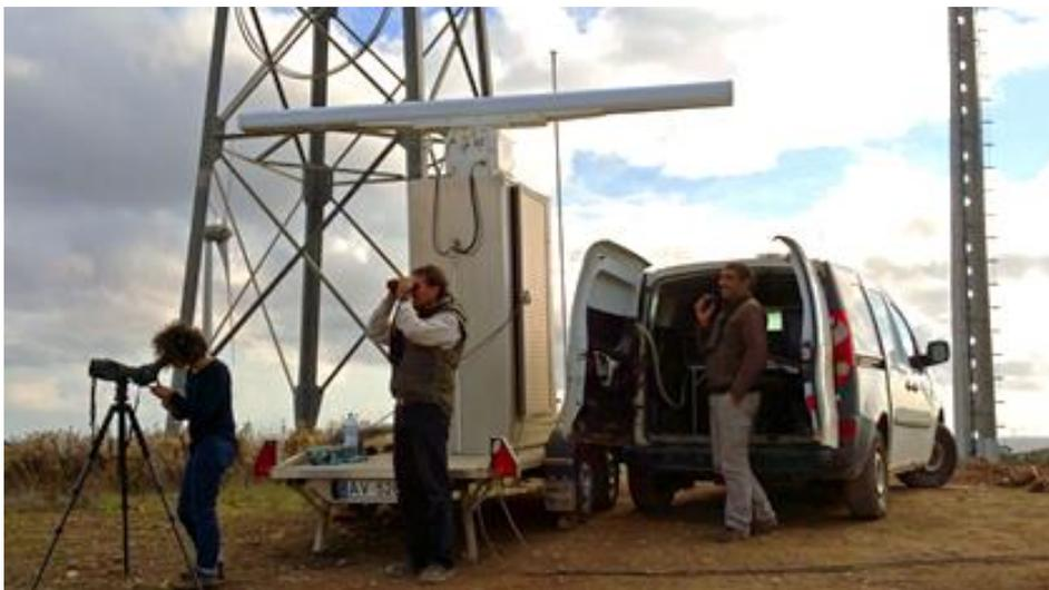
Figura 3.4 – Unidade móvel de RADAR
