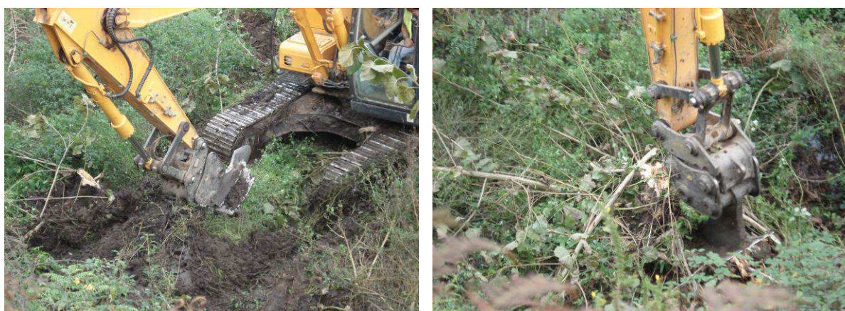
Figura 3 e 4 - Arranque e enterramento de toijas com enxó
