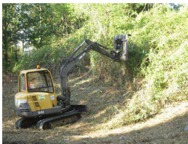
Figura 31 - Limpeza de matos mecânica: corta-matos
