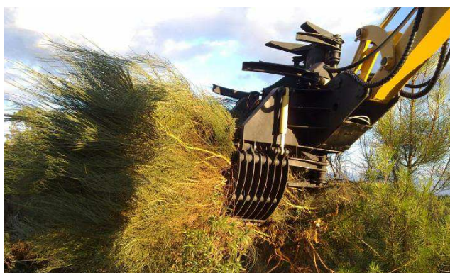
Figura 33 - Limpeza de matos mecânica: arrancador de matos (e.g. CLEAN-R1 system)
