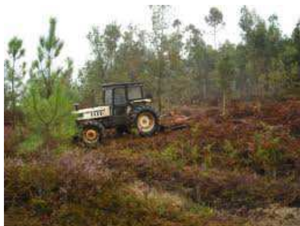
Figura 31 - Limpeza de matos mecânica: corta-matos
