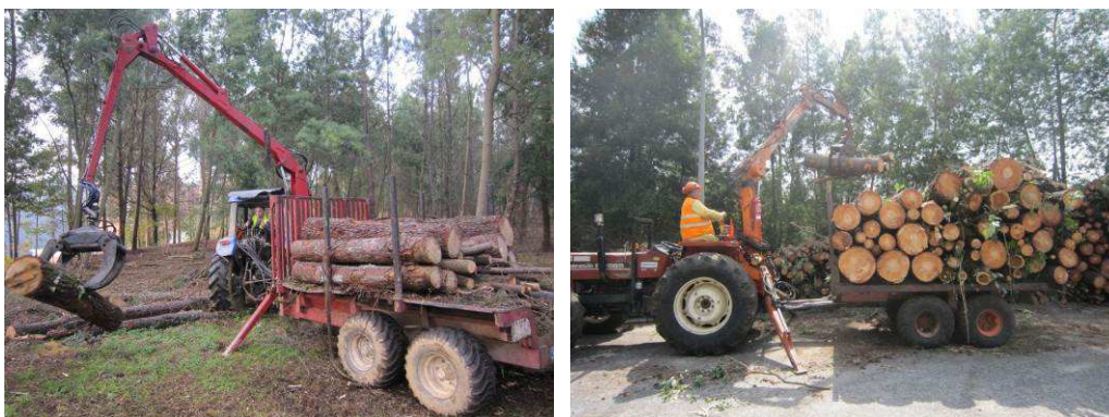
Figura 23 - Transporte da madeira para carregadouro e empilhamento
