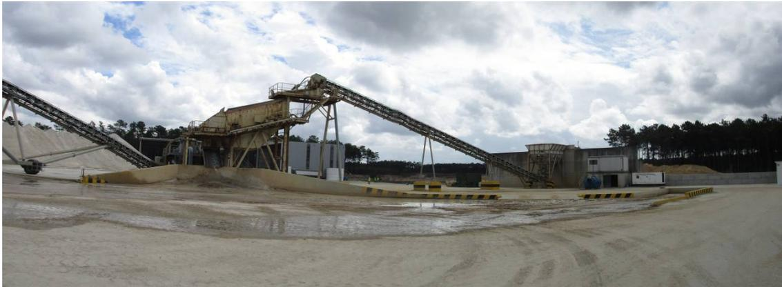
Fotografia 1 - Equipamentos constituintes do processo de lavagem e crivagem de areias (28-08-2017).
