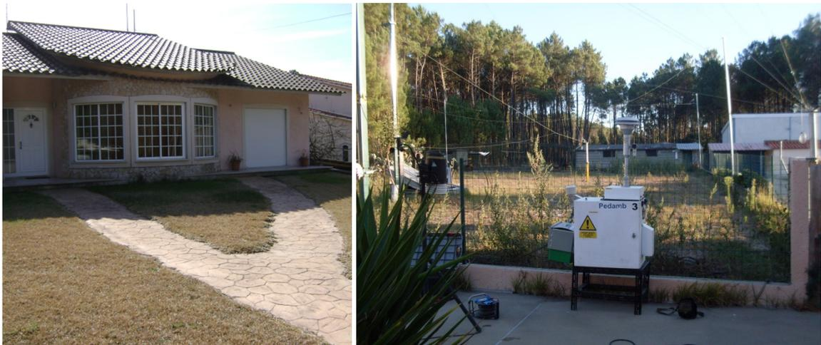
Figura 1 - Amostrador sequencial usado no ponto de medição a Oeste da unidade extractiva
