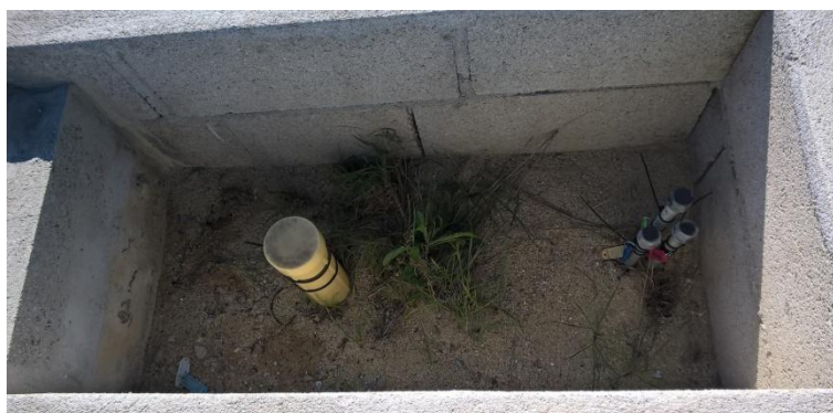
Fig.7 - Aspecto de um inclinómetro integrado com piezómetro triplo.
