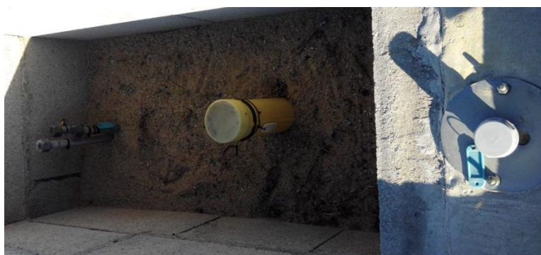
Fig.9 - Extensómetro integrado com inclinómetro e piezómetro triplo.
