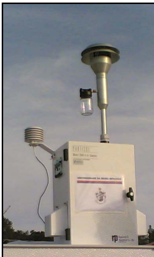
Figura 2- Amostrador de partículas no local de amostragem Retaxo apeadeiro da CP.
