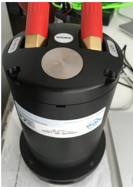
Figura 5 – Equipamento ADCP Signature 1000.
