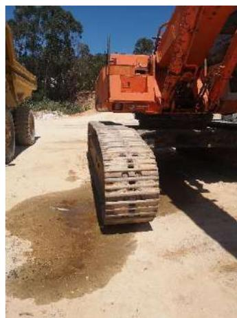
Foto 6 – Derrame de óleo vertido de máquina estacionada em zona não impermeabilizada
