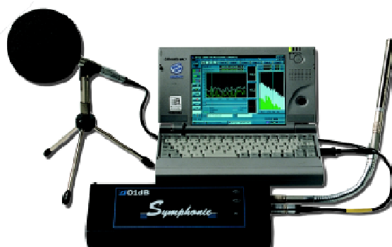
Figura 3.6 – Sistema Symphonie – Sonómetro de Precisão Tipo 1; Analisador em Tempo Real; Gravador Áudio; Registador gráfico
