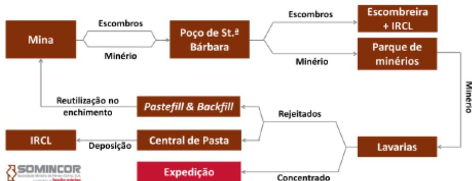
Figura 1 - Esquema simplificado do ciclo produtivo no Complexo Mineiro de Neves-Corvo
