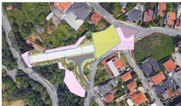
Figura 8 - Integração na malha urbana da transição entre o Viaduto de Santo Ovídio e o emboquilhamento do túnel, com novo arruamento para acesso a carro de bombeiros.
