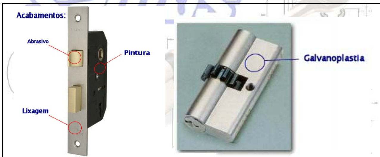
Figura 6: Resultado dos vários tipos de acabamentos das várias peças que constituem uma fechadura
