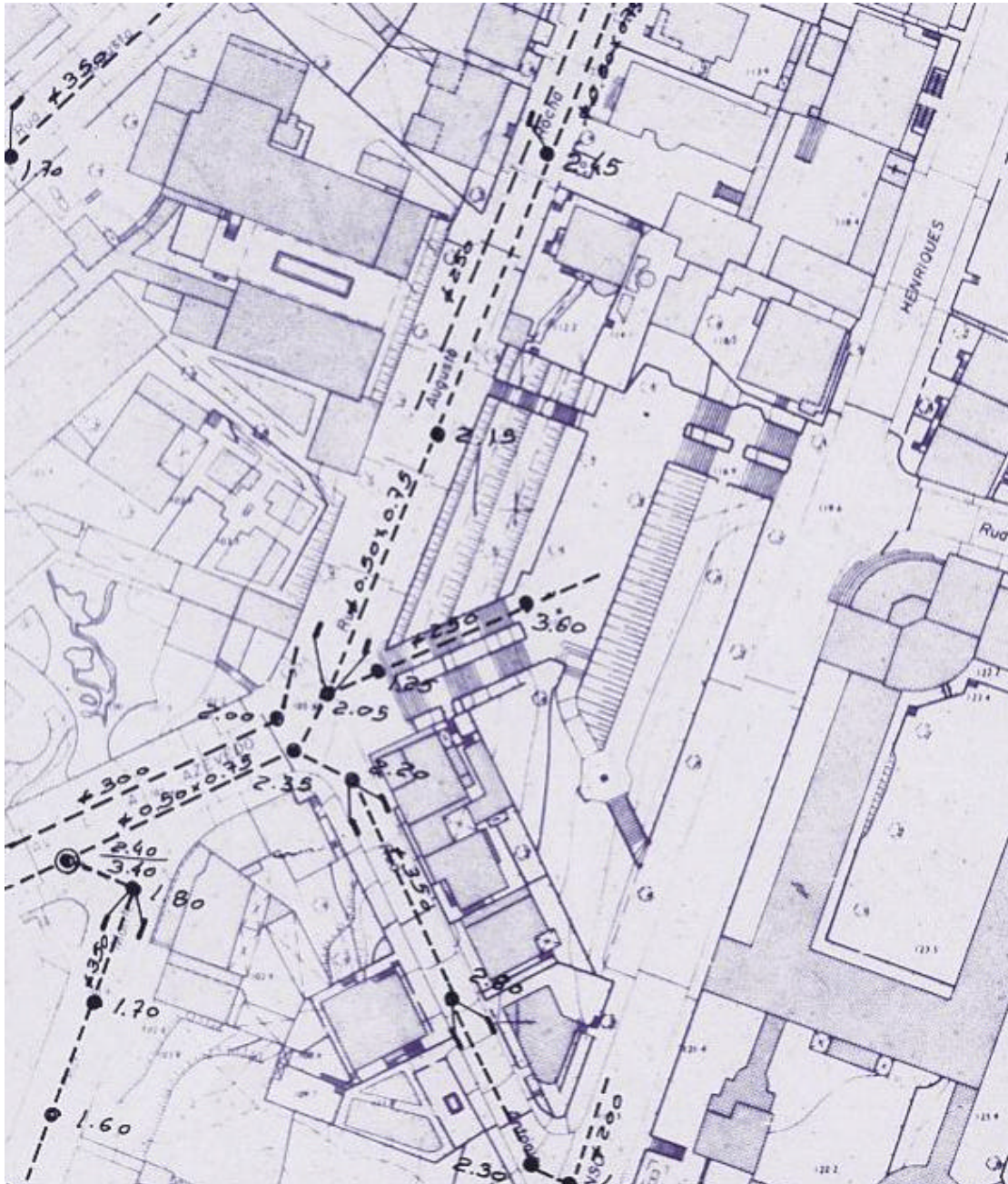
Figura 1 – Serviços de saneamento ao longo da Rua Augusto Rocha
