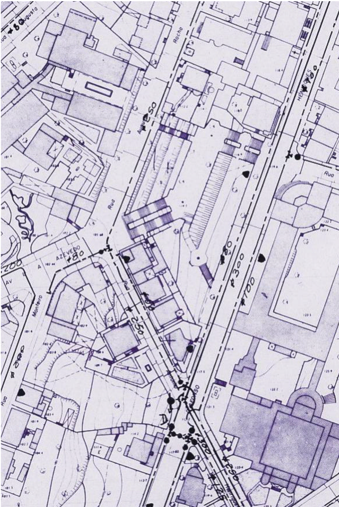
Figura 2 - Serviços de águas ao longo da Rua Augusto Rocha
