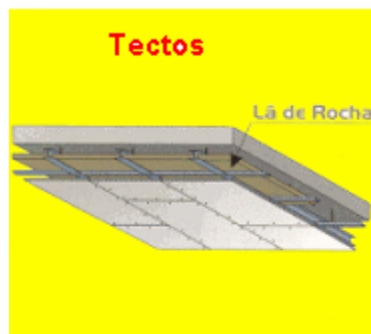
Fig. 1.4. Utilização da lã de rocha em tectos.
