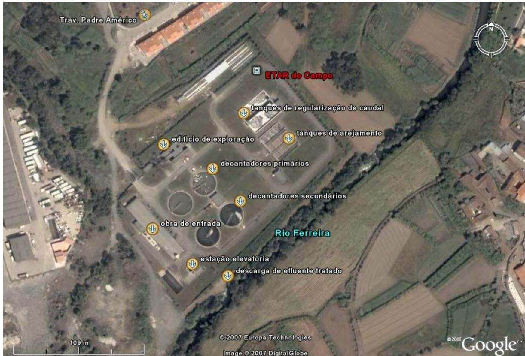
Figura I.2 – Vista aérea da ETAR de Campo. Localização dos principais órgãos de tratamento e edifícios de apoio. (Google Earth, Janeiro 2007).
