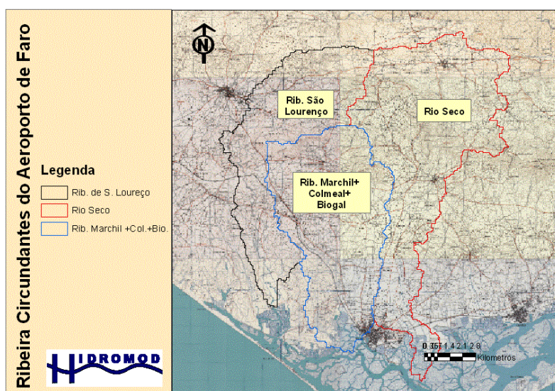
Figura 19 – Ribeiras circundantes do Aeroporto de Faro. Bacias hidrográficas obtidas com topografia da NASA-SRTM com uma malha de aproximadamente 70 metros
