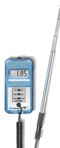
Figura 5.11.3 – Ilustração do anemómetro velocichек utilizado na avaliação das condições meteorológicas.
