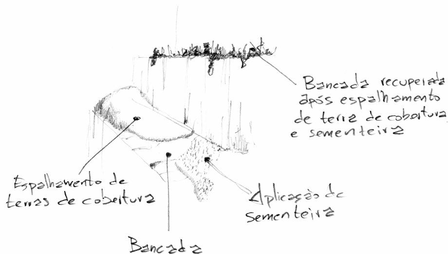
Figura 3.2.17 – Esquema com processo de intervenção nas bancadas.
