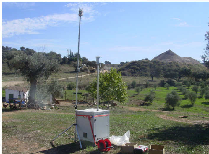
Figura 5.12.2 – Estação Móvel de Qualidade do Ar.
