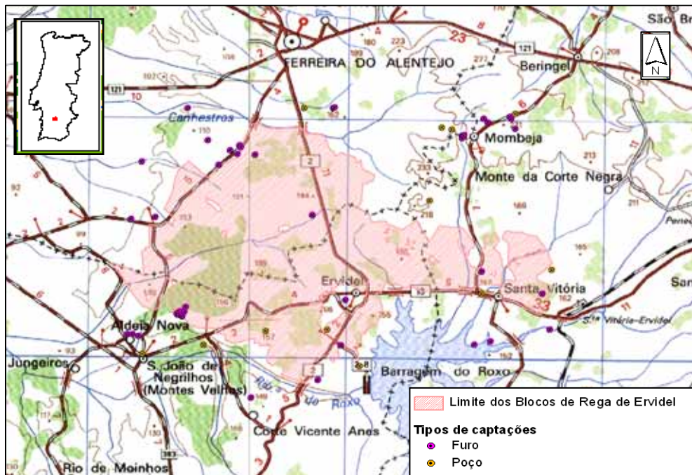
Figura 6-72 – Outras captações de água subterrânea inventariadas na área de incidência do projecto no âmbito do Projecto ERHSA
