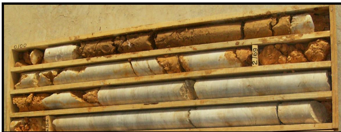
Fig. 13 - Solo que ocorre no início da sondagem.
