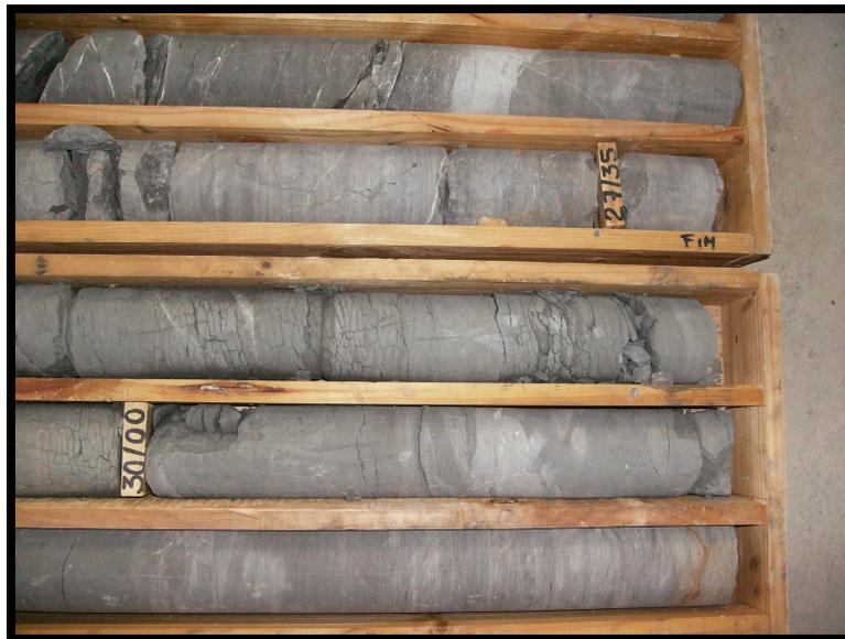
Fig. 16 – Marga, 24 horas após ser molhada
