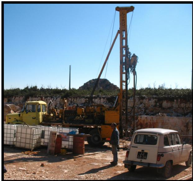
Figura 5.3.6 – A sonda BE 1656 utilizada nas sondagens.
