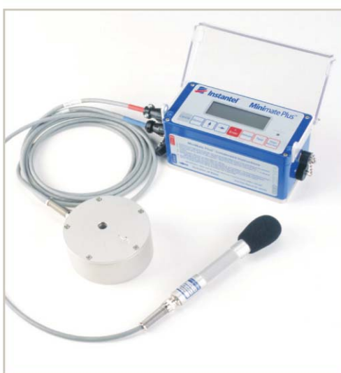
Figura 1 – Componentes do sismógrafo de engenharia utilizado na monitorização
