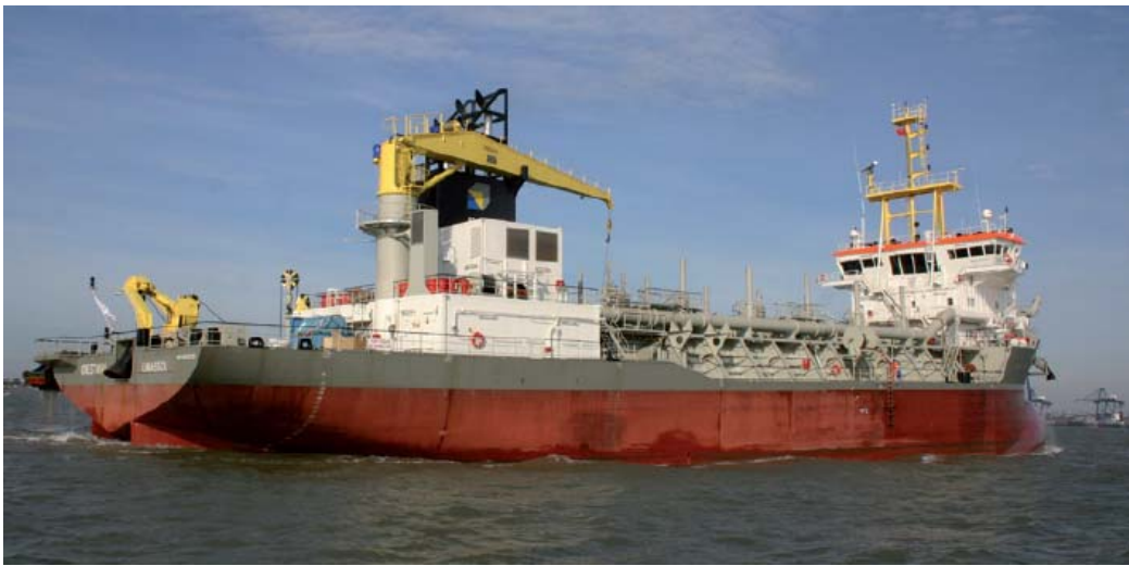
Figura 3.3 – Exemplo de draga de sucção em marcha com armazenamento
