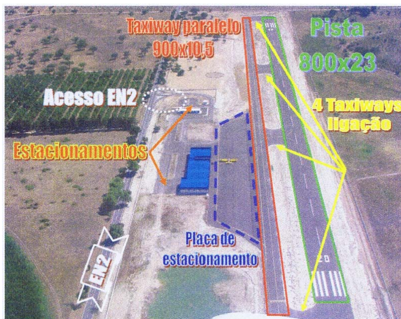
Figura 1 – Aeródromo Existente em Janeiro de 2009
