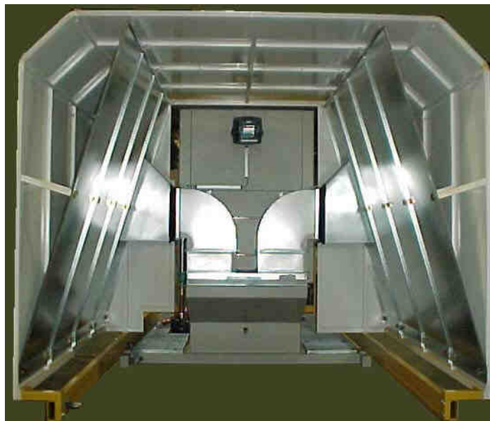
Figura 6 - Electro filtro com duas secções de filtragem
