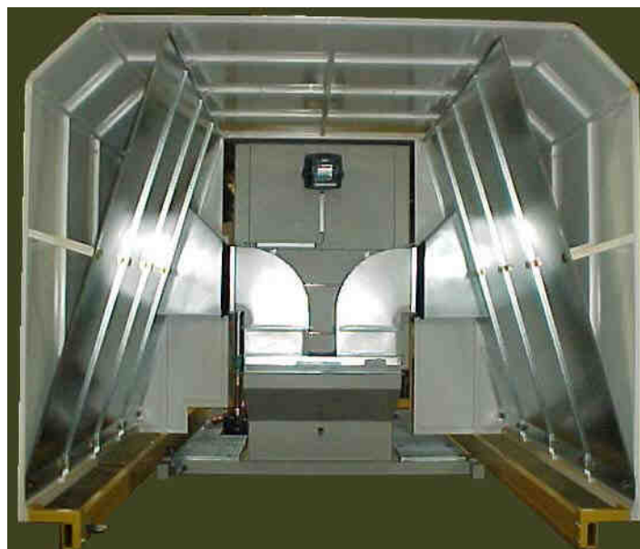
Figura 19 – Equipamento de Extracção e Filtragem KMA Ultravent – Filtro de Entrada
