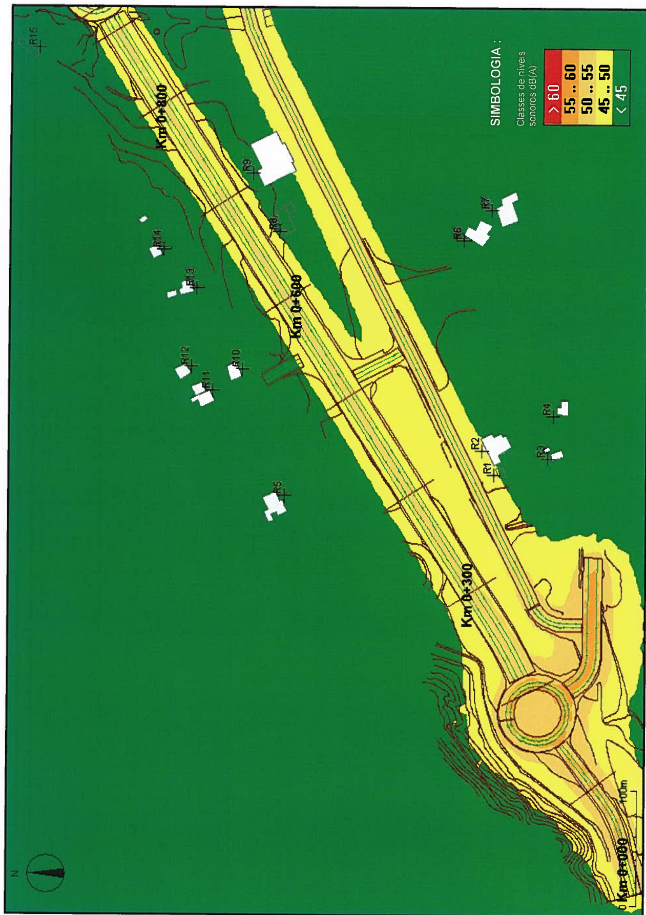
Linhas Isofônicas para os Níveis Sonoros na Situação Futura com Aplicação de Pavimento Modificado em Borracha – Indicador Ln Circular Norte de Silves – km 0+000 ao km 0+875
