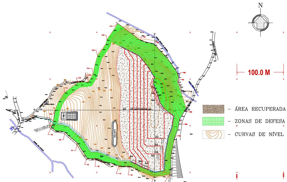
Figura 3.2.7 – Representação esquemática da pedreira (3.ª fase)
