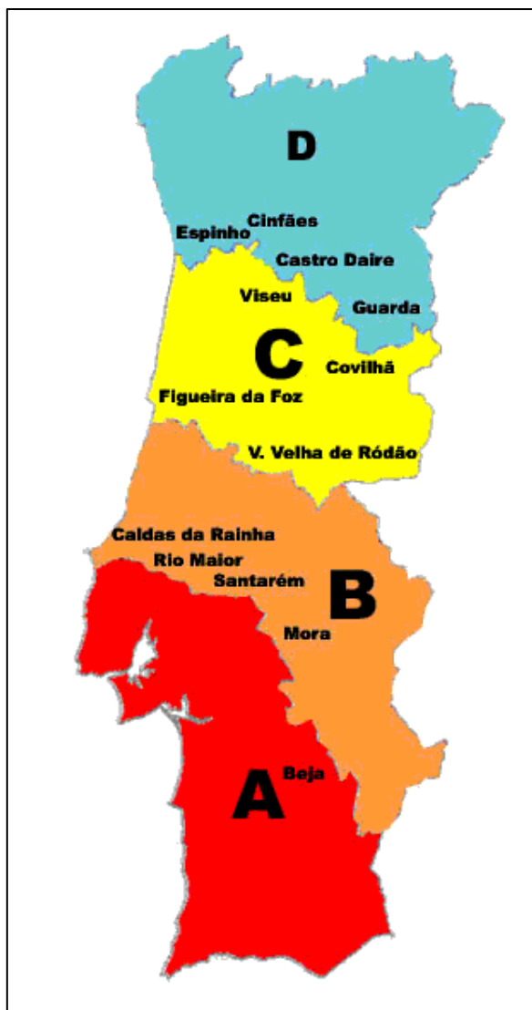
Figura 2.8 – Zonamento do risco sísmico em Portugal Continental.
