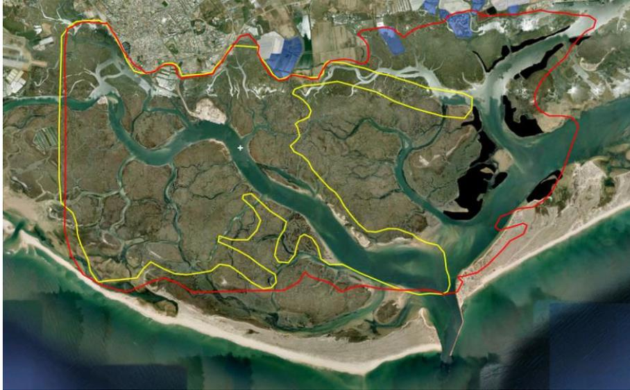
**Figura 18 - Zona de mistura estimada para a descarga em Faro Nascente em situação de maré viva. Amarelo - concentração na descarga de  $2 \times 10^3$  NMP/100 ml; Vermelho - concentração na descarga de  $1 \times 10^4$  NMP/100 ml.**
