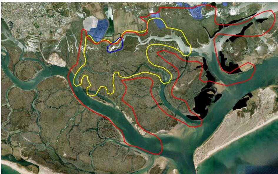
**Figura 17 - Zona de mistura estimada para a descarga em Faro Nascente em situação de maré viva. Azul - concentração na descarga de 300 NMP/100 ml; Amarelo - concentração na descarga de  $2 \times 10^3$  NMP/100 ml; Vermelho - concentração na descarga de  $1 \times 10^4$  NMP/100 ml.**
