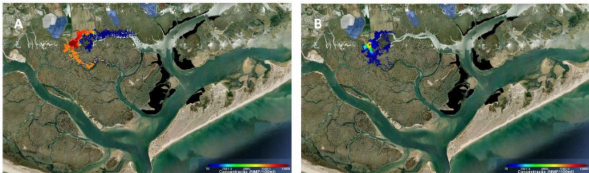
**Figura 21 - Pluma Microbiológica obtida no período de maré morta para a descarga em Faro Nascente. Concentração da descarga igual a  $1 \times 10^4$  NMP/100 ml. A) Condições de baixa-mar e noite; B) Condições de preia-mar e dia.**
