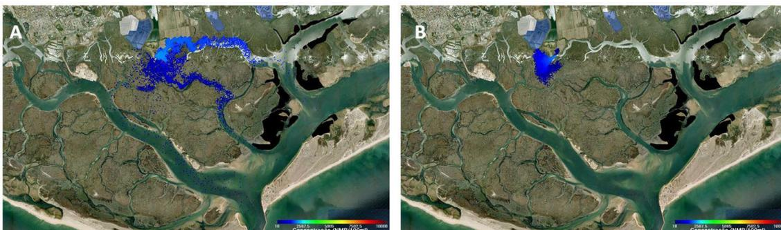
**Figura 28 - Pluma Microbiológica obtida no período de maré viva para a descarga em Faro Nascente. Concentração da descarga igual a  $2 \times 10^3$  NMP/100 ml. A) Condições de baixa-mar e noite; B) Condições de preia-mar e dia.**
