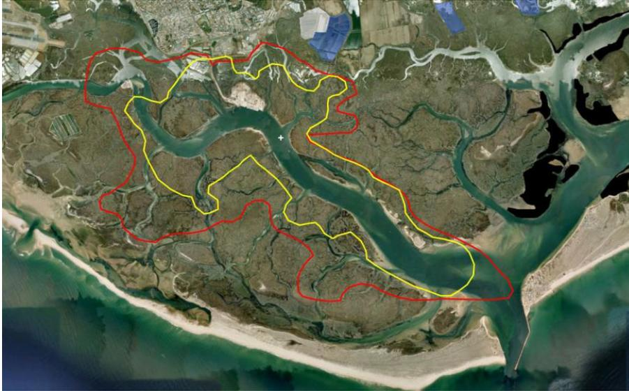
**Figura 16 - Zona de mistura estimada para a descarga em Faro Nascente em situação de maré morta. Amarelo - concentração na descarga de  $2 \times 10^3$  NMP/100 ml; Vermelho - concentração na descarga de  $1 \times 10^4$  NMP/100 ml.**
