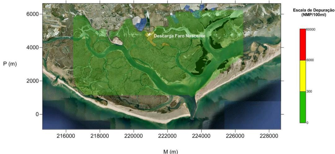
**Figura 2 - Distribuição espacial da concentração de coliformes fecais em bivalves *Tapes decussatus* para a descarga em Faro Nascente e concentração na descarga de  $2 \times 10^3$  NMP/100 ml. Situação de maré morta.**
