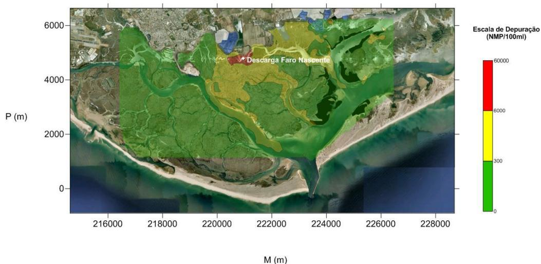
**Figura 7 - Distribuição espacial da concentração de coliformes fecais em bivalves *Tapes decussatus* para a descarga em Faro Nascente e concentração na descarga de  $1 \times 10^4$  NMP/100 ml. Situação de maré viva.**
