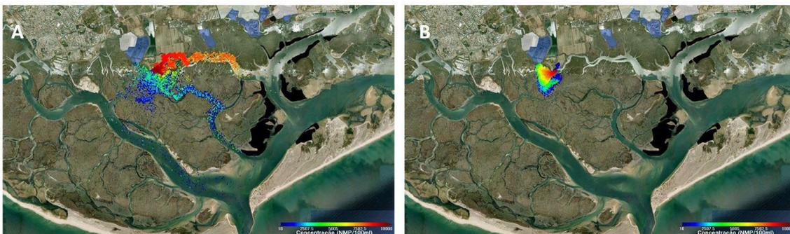
**Figura 27 - Pluma Microbiológica obtida no período de maré viva para a descarga em Faro Nascente. Concentração da descarga igual a  $1 \times 10^4$  NMP/100 ml. A) Condições de baixa-mar e noite; B) Condições de preia-mar e dia.**
