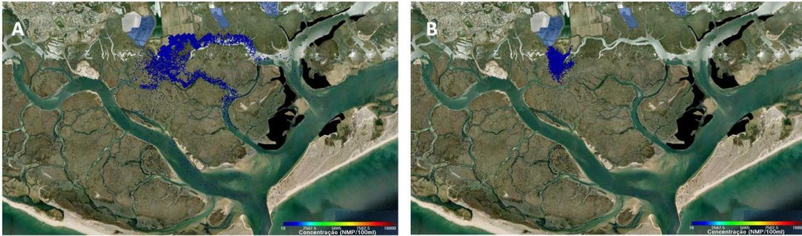
**Figura 29 - Pluma Microbiológica obtida no período de maré viva para a descarga em Faro Nascente. Concentração da descarga igual a 300 NMP/100 ml. A) Condições de baixa-mar e noite; B) Condições de preia-mar e dia.**
