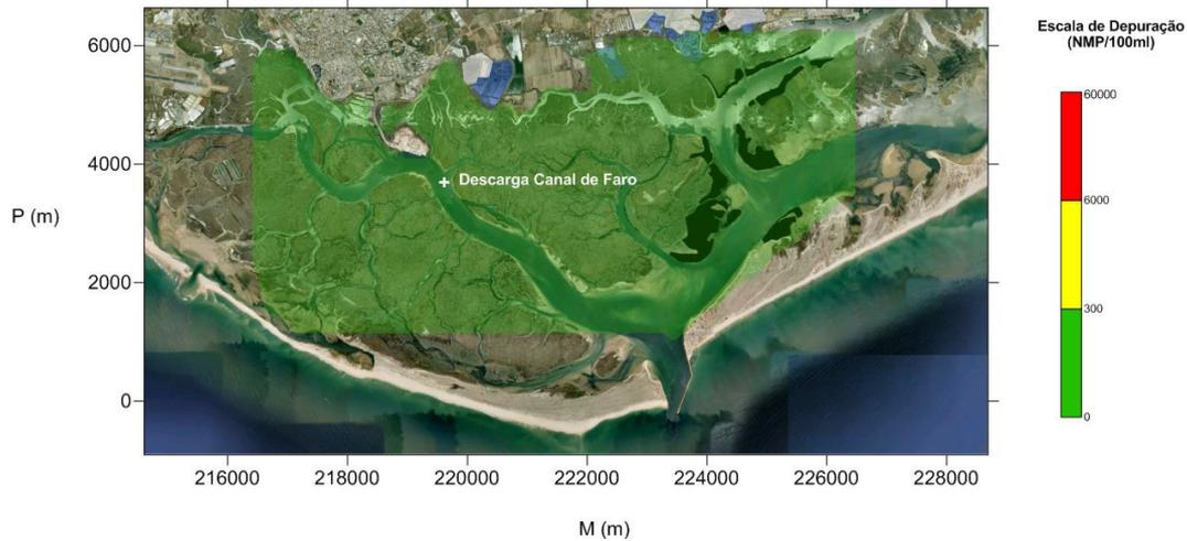
**Figura 6 - Distribuição espacial da concentração de coliformes fecais em bivalves *Tapes decussatus* para a descarga no Canal de Faro e concentração na descarga de 300 NMP/100 ml. Situação de maré morta.**
