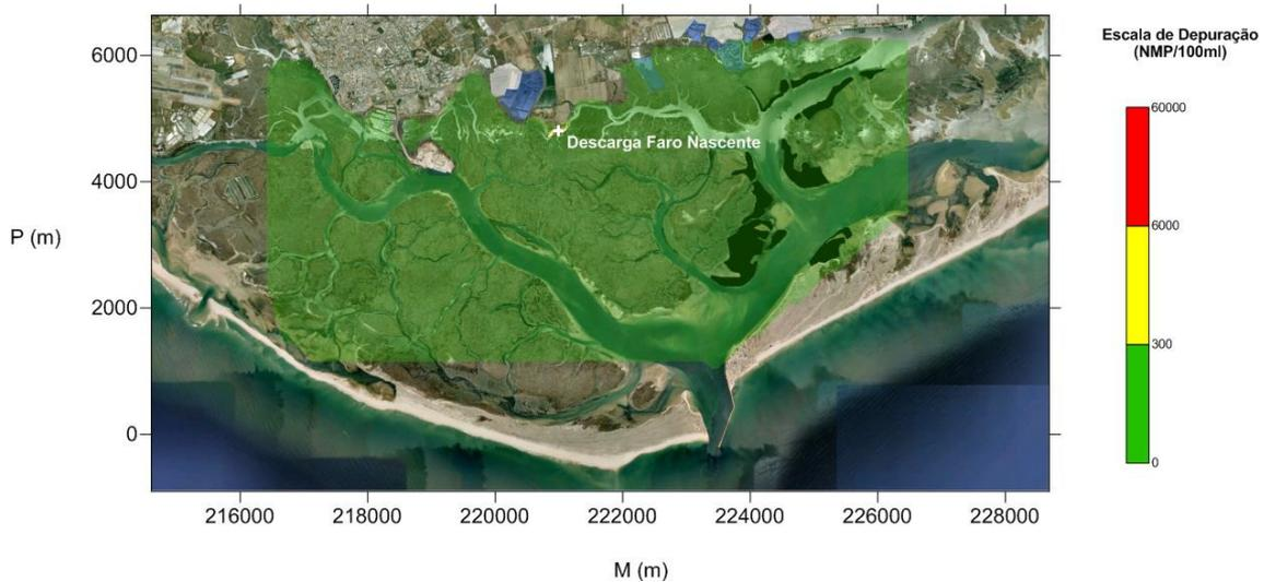
**Figura 9 – Distribuição espacial da concentração de coliformes fecais em bivalves *Tapes decussatus* para a descarga em Faro Nascente e concentração na descarga de 300 NMP/100 ml. Situação de maré viva.**
