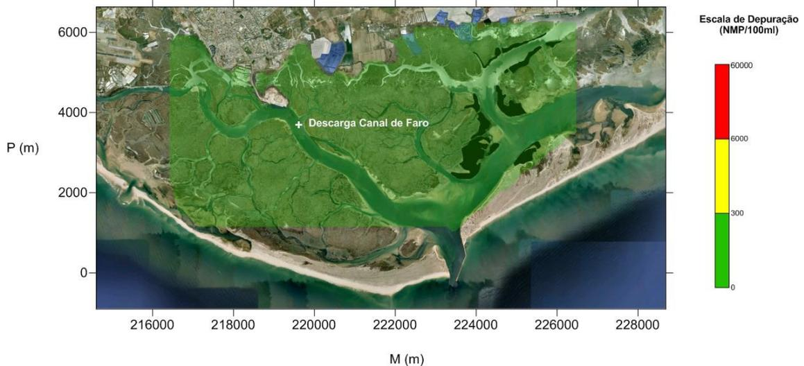
**Figura 12 - Distribuição espacial da concentração de coliformes fecais em bivalves *Tapes decussatus* para a descarga no Canal de Faro e concentração na descarga de 300 NMP/100 ml. Situação de maré viva.**
