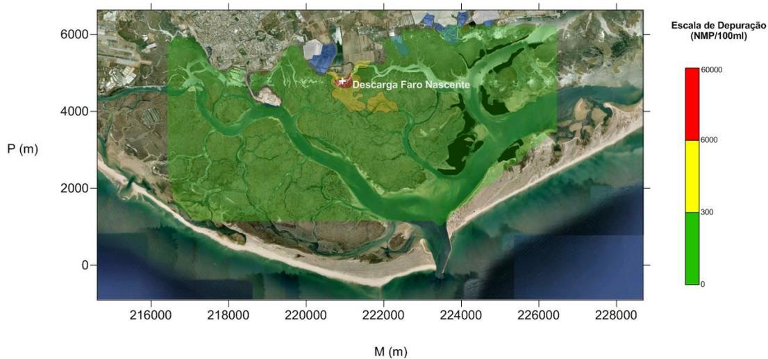
**Figura 1 - Distribuição espacial da concentração de coliformes fecais em bivalves *Tapes decussatus* para a descarga em Faro Nascente e concentração na descarga de  $1 \times 10^4$  NMP/100 ml. Situação de maré morta. .**
