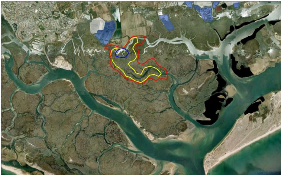
**Figura 15 - Zona de mistura estimada para a descarga em Faro Nascente em situação de maré morta. Azul - concentração na descarga de 300 NMP/100 ml; Amarelo - concentração na descarga de  $2 \times 10^3$  NMP/100 ml; Vermelho - concentração na descarga de  $1 \times 10^4$  NMP/100 ml.**
