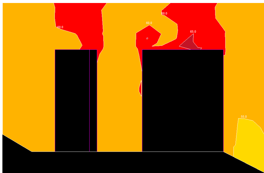
Figura 4 – Corte esquemático, transversal às instalações existentes e futuras da Fapricela, previstos para a área do PIN, com os valores dos indicadores Lden.
