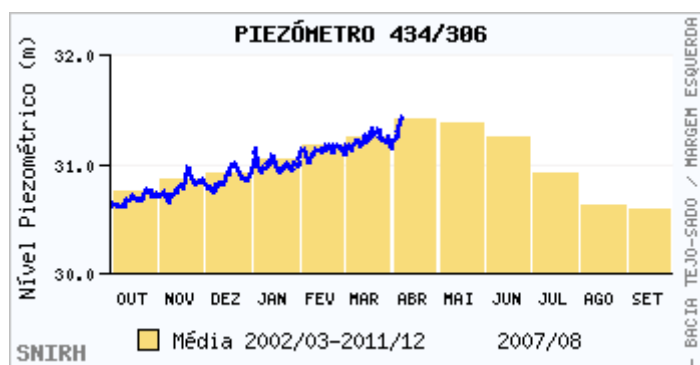
Figura 47 -Variação do nível piezométrico no ponto de água 434/306 em 2007/2008. Fonte: SNIRH.
