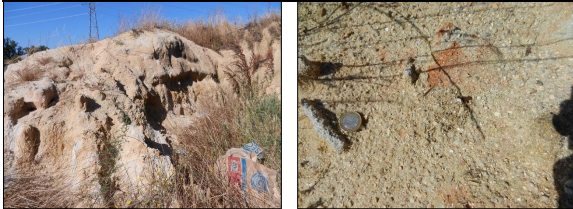
Figura 24– À esquerda: afloramento de depósitos detríticos mio-pliocénicos no local do projecto; à direita: pormenor do material gresoso.
