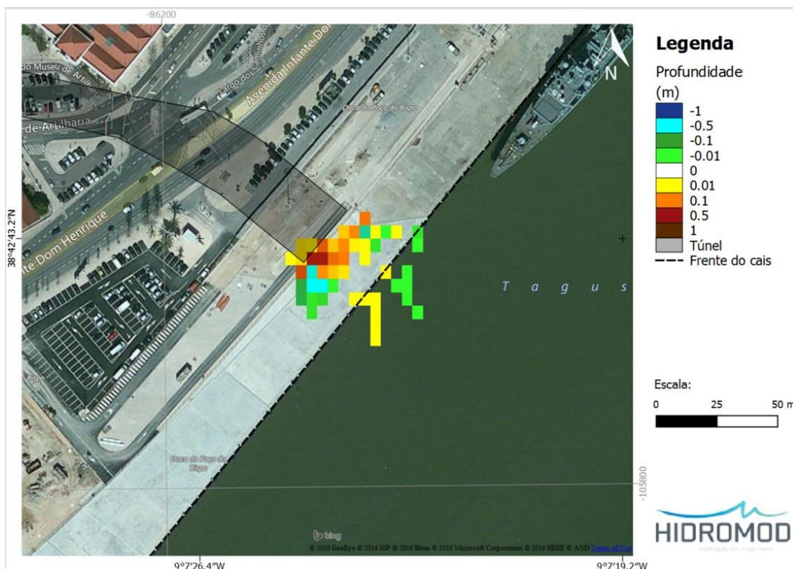
Figura 47 - Santa Apolónia, variação batimétrica relativa para um cenário de caudal de cheia com período de retorno de 100 anos, maré viva e descarga sem muro.
