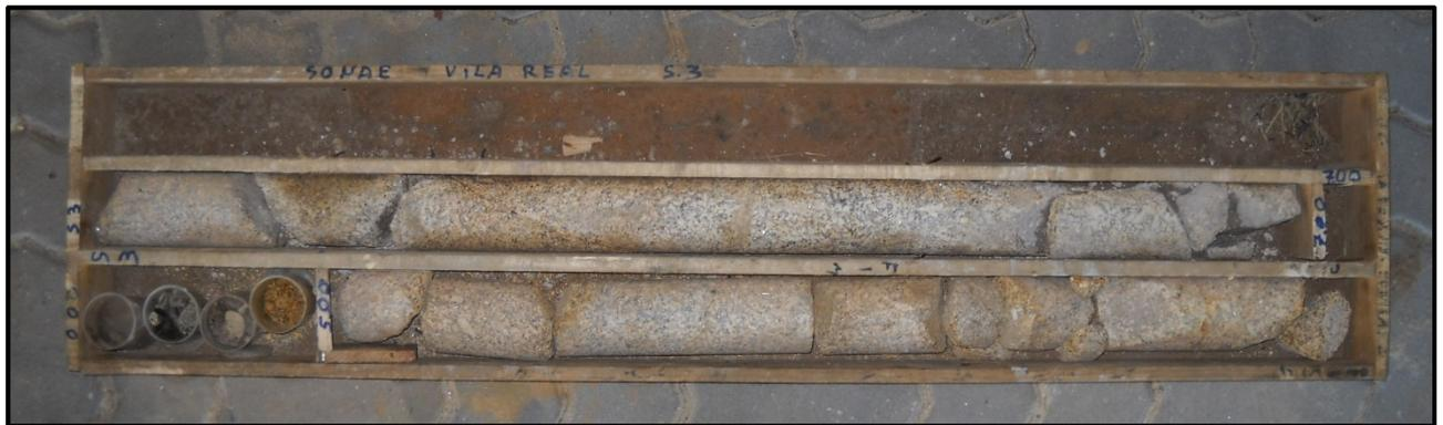
Figura 4: Acondicionamento das amostras/tarolo do maciço rochoso ocorrente em caixa de madeira.
