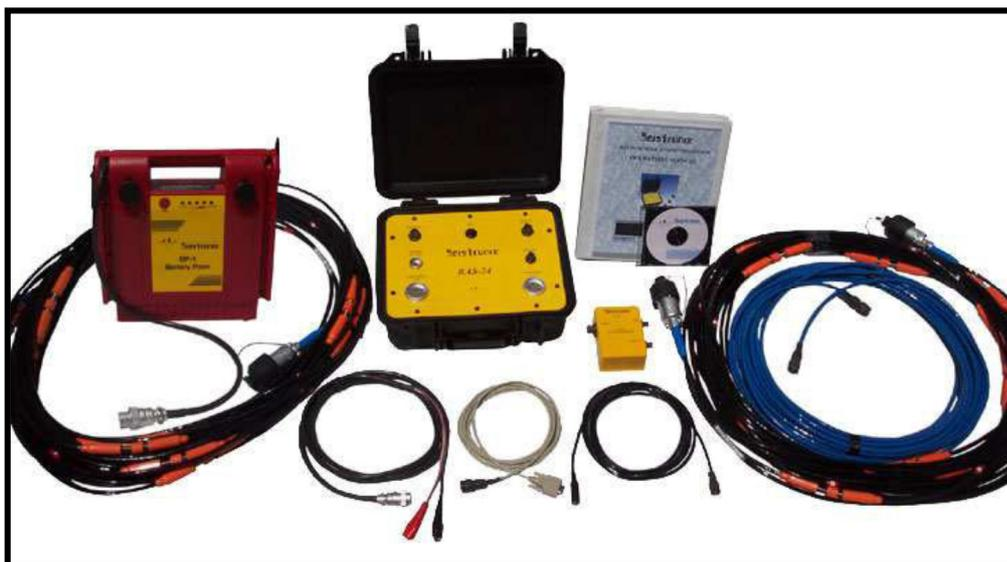
Figura 5: Equipamento utilizado para a execução dos perfis de refração sísmica.
