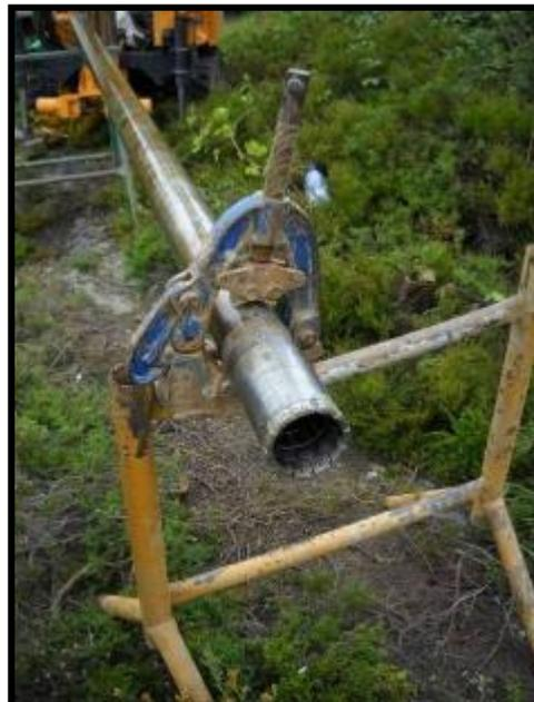
Figura 3: Ferramenta de corte utilizada para a recuperação em contínuo do maciço reconhecido.
