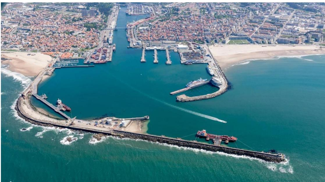
Figura 1 – Vista geral do Porto de Leixões e dos quebra-mares existentes
