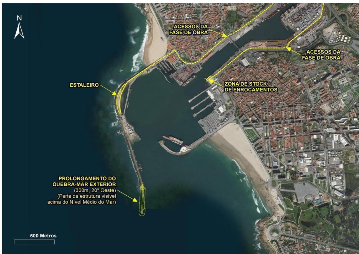
Figura 2 – Prolongamento do quebra-mar exterior: implantação, acessos e áreas de apoio à construção (Fonte: EIA, 2018)
