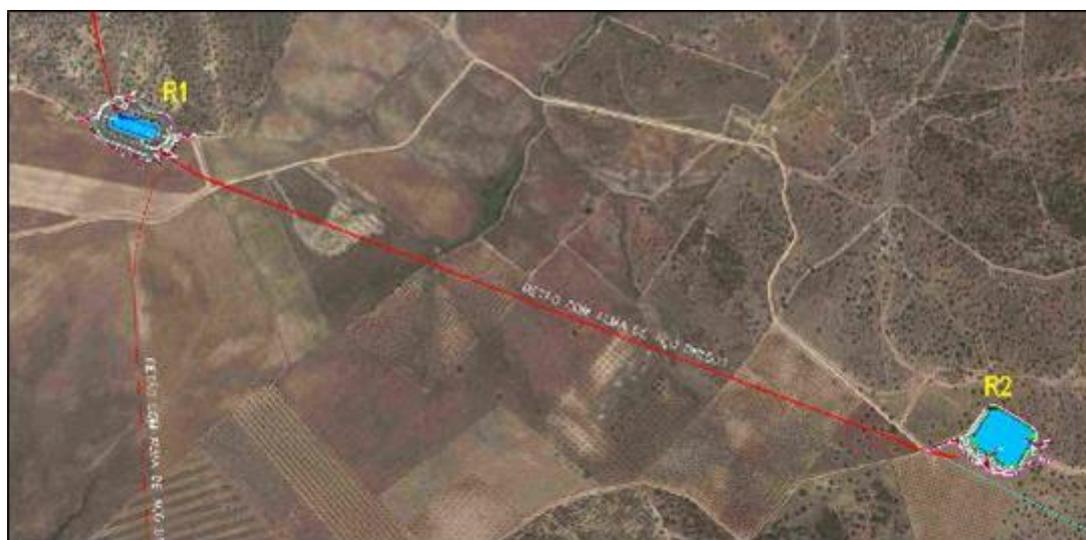
Figura 3.8 – Implantação da conduta gravítica C1 (R1-R2)
