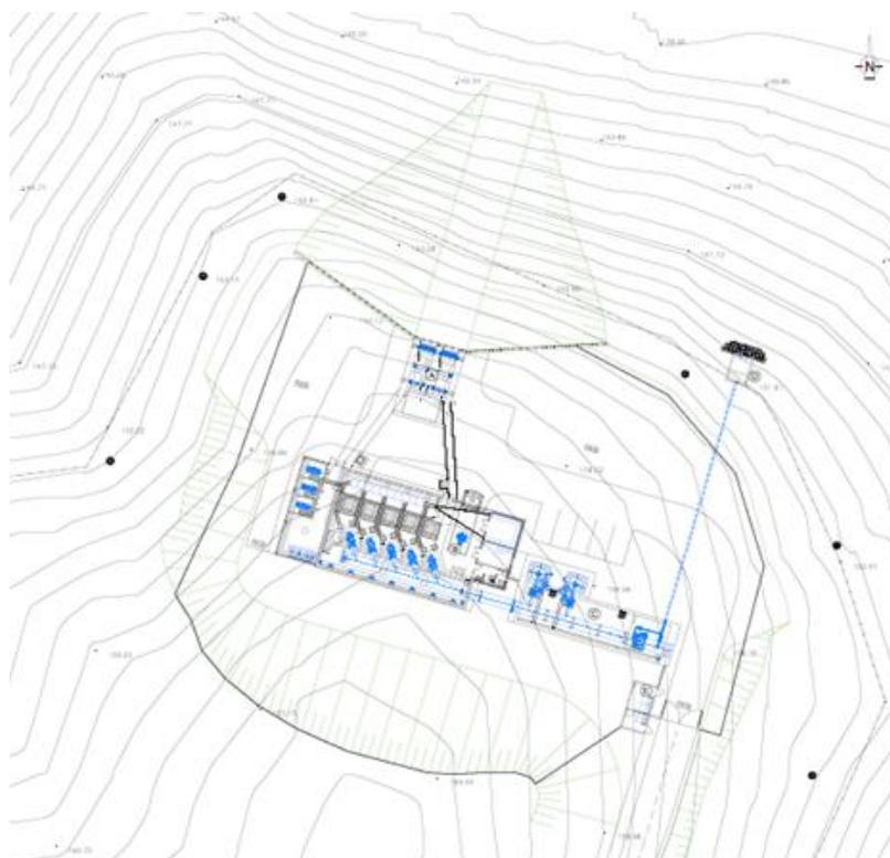
Figura 3.3 – Implantação da Captação
