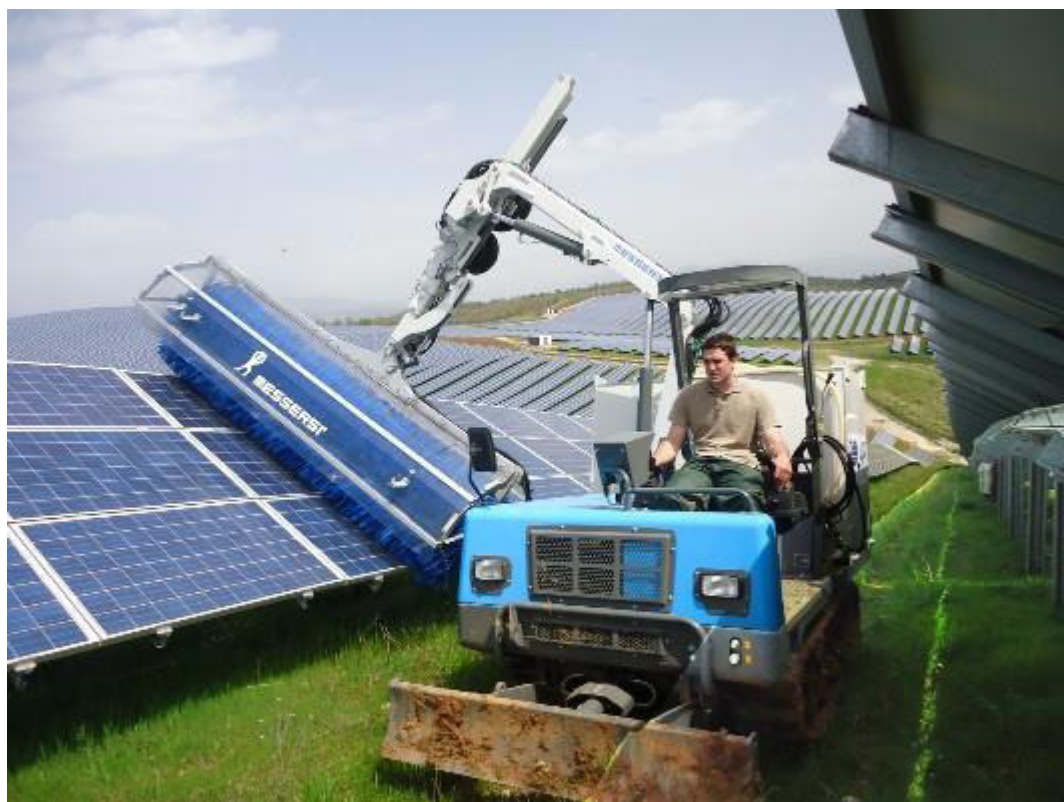
Fotografia 4.10 – Exemplo do equipamento para limpeza dos painéis fotovoltaicos
