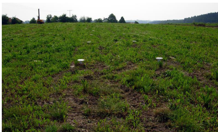
Fotografia 4.8 – Parafusos fixados ao solo
