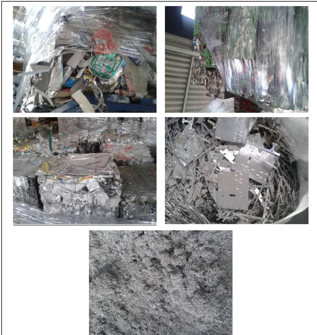
Figura 4.12 – Exemplos dos resíduos de alumínio que compõem os lingotes utilizados como matéria-prima.
