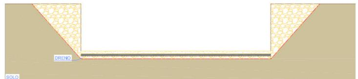
Para um solo consolidado (com capacidade de resistência mínima de 250 KPa), recomenda-se uma laje em betão armado C30/37 XC2, com uma malha inferior e superior de ferro 12mm, afastado a 20 cm e com espessura 30 cm.;
