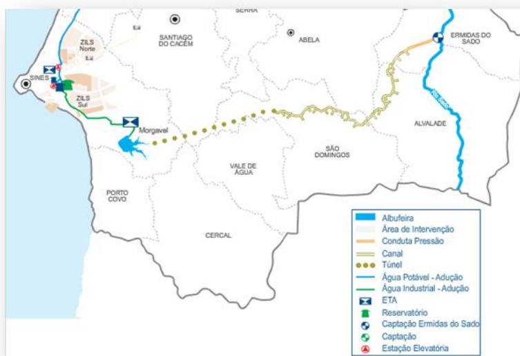
FIG. II. 1 – Esquema geral do Subsistema de Abastecimento de Água Industrial. (extraído de prospeto oficial da AdSA)
