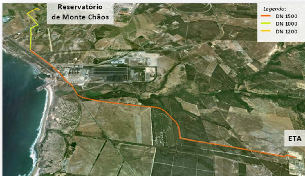
FIG. II. 2 – Conduta adutora existente (visão geral) (elaborado a partir de shapefiles do Cadastro da AdSA em GoogleEarth® )
