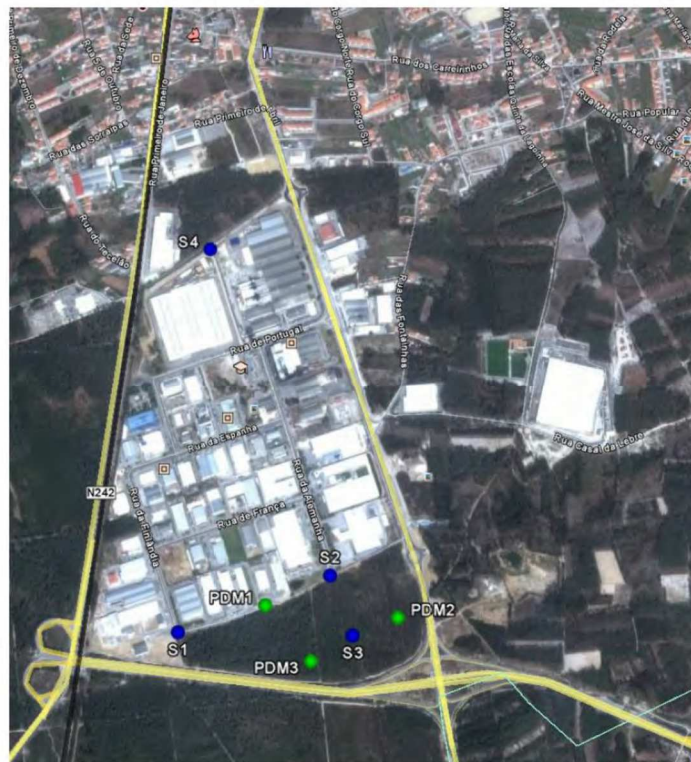
Figura 2– Locais propostos para instalação dos piezómetros para monitorização das águas subterrâneas (Fonte: Estudo geológico-geotécnico, Riportico, 2015)
