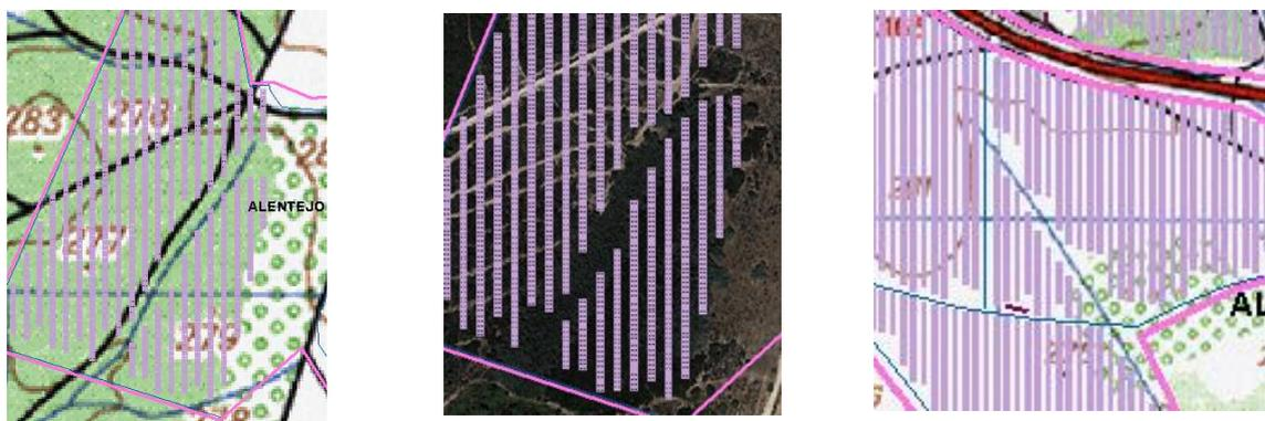
**Figura 3.** Implantação de painéis fotovoltaicos, subárea A1
