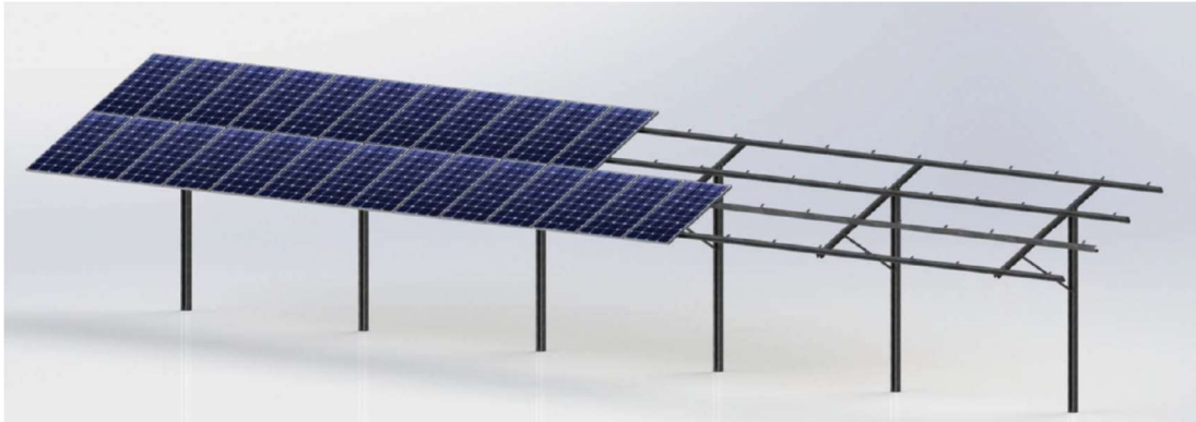
Figura 14.3 - Estrutura de fixação e suporte de módulos.
