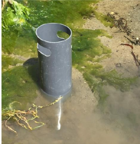
**Figura 5** – Core utilizado na amostragem de invertebrados bentônicos.
