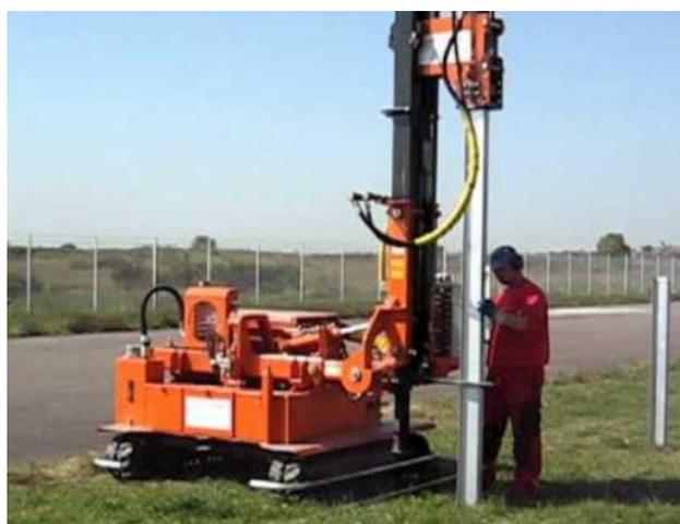
**Figura 13:** Máquina bate estacas.
