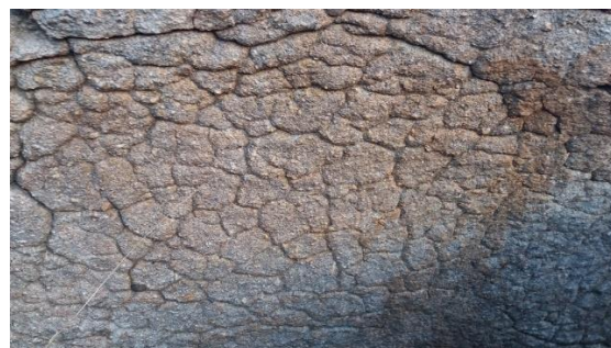
Fotografia 6.5 – Pormenor de blocos graníticos na zona de contacto do maciço granítico com a Formação de Marão. À direita pormenor da alteração da face do bloco fraturado (tipo broa).
