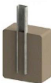
Figura 4.5 – Fundação de cravação direta no solo.
