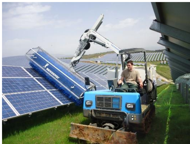
Fotografia 4.9 – Exemplo do equipamento para limpeza dos painéis fotovoltaicos.
