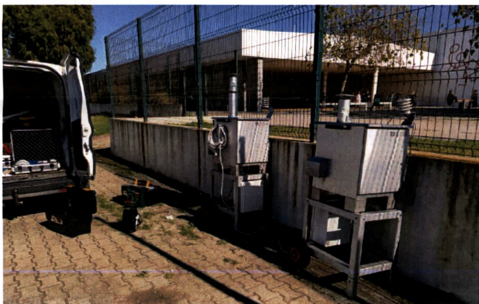
Figura 1 – Instalação do equipamento para medição de PM_{10} e PM_{2,5} junto à Escola Secundária Poeta Al Berto no dia 30 de outubro de 2020.
