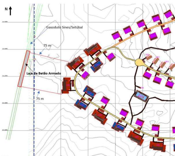
Fig. 5 - Extensão do Gasoduto com laje de betão armado de proteção a construir na envolvente do empreendimento
