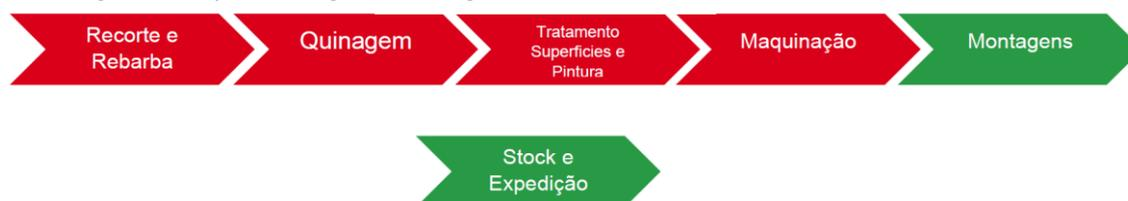
A secção do Recorte e Rebarba labora em 3 turnos com uma média diária de 14 trabalhadores com uma afetação de 6 máquinas, permitindo realizar uma média de 4000 peças. A secção de Quinagem, labora em 2 turnos com uma afetação média de 11 trabalhadores e realiza uma média de 64 horas de trabalho com as 5 máquinas da secção.
